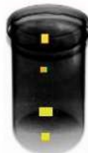
Obrázek 3 Identifikace kontaminantů ve skleněných konzervách – zde masová konzerva („sklo ve skle“).
